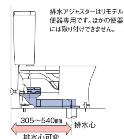
新ピュアレストQRは設備排水管の移設を行わずに、便器が取り替えられるリモデル便器をご用意しています。給水管はフレキホースとなっており、広い範囲での給水位置に対応しています。また、便器前出寸法が760mmとコンパクトなので、レギュラー便器からの取り替えにも適しています。
